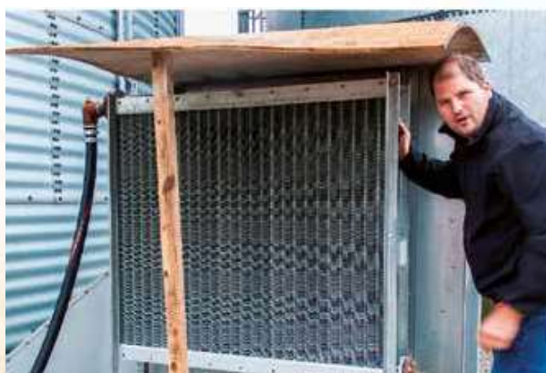
Kaloriferen hæver udetemperaturen med 14 grader, og sidste år fik vi tørret kornet ned fra 18,8 til 15 procent vand på 10 dage. Der blev brugt en del halm i de dage, siger Morten Vilsgaard.
