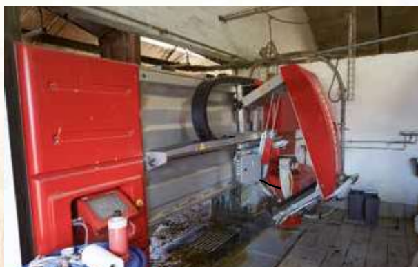
Malkerobotten rengøres med 90 grader varmt vand fra halmfyret.
